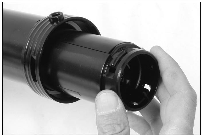
3. La douille en spirale étant complètement retirée, elle peut être soit nettoyée soit remplacée.
